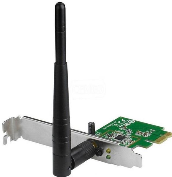
Рис. 1.13. Беспроводной сетевой адаптер
