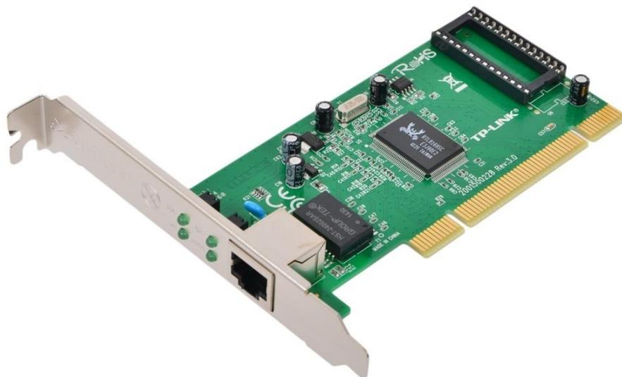
Рис. 1.14. Сетевой адаптер в виде платы расширения
